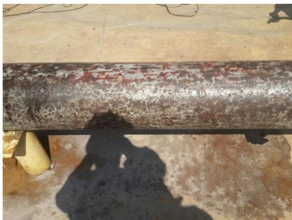
高圧水と鋼製のブラシで洗浄した後のパイプの例
